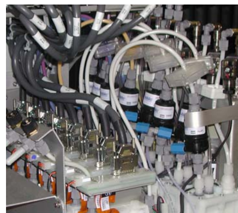
Contadores de 1 x 3 de SuperPhobic® instalados en una impresora de inyección de tinta de formato ancho
